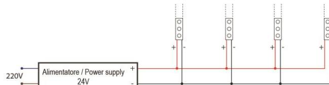
NON COLLEGARE I LED DIRETTAMENTE ALLA TENSIONE DI RETE / DO NOT CONNECT LEDs DIRECTLY TO 220V
